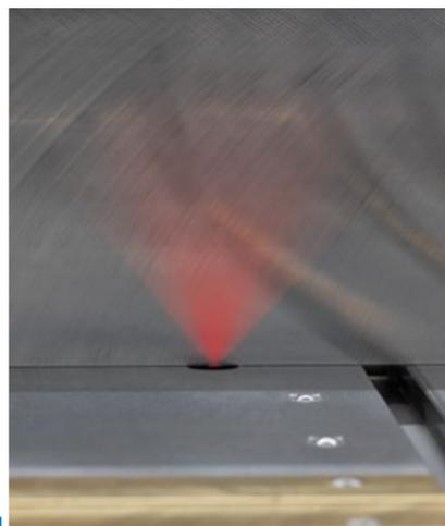
Automatisches Längenmesssystem für Besäumschnitte.
