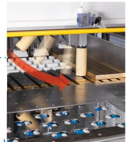
Pneumatisch gesteuerte Anpresseinheit für Streifenschnitte.
