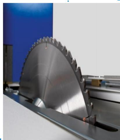
Geschlossene Sägewagenabdeckung für hervorragende Absaugergebnisse.
