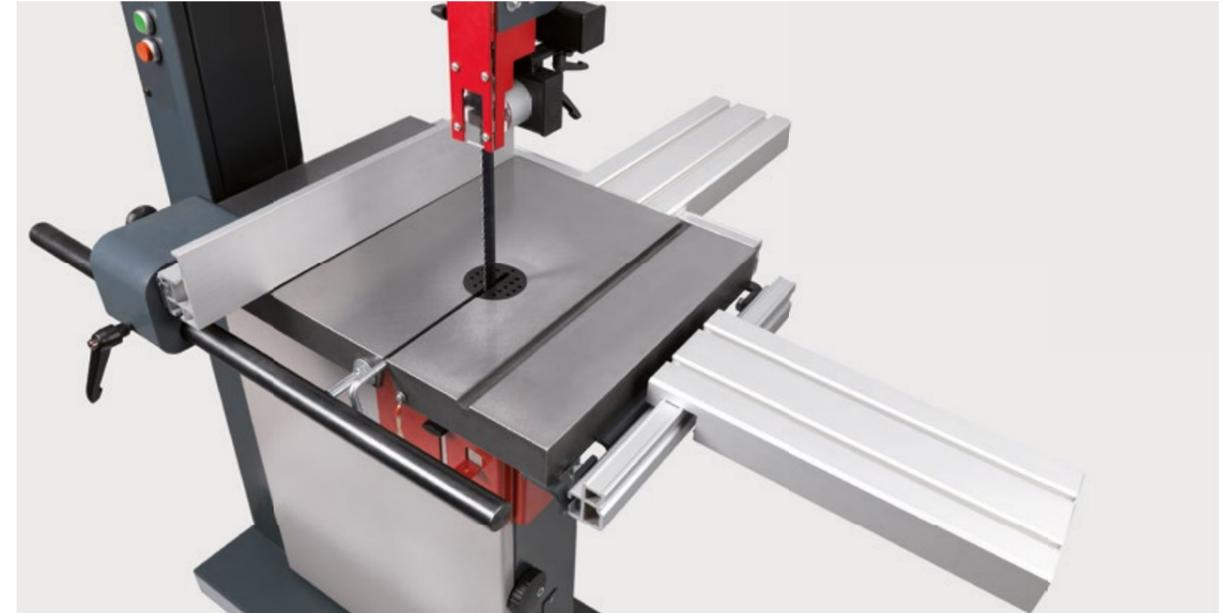
**Bei Bedarf: Tischgrößen an Werkstückgröße anpassen**
