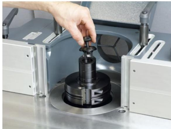
**"Quick-Lock" cambio de herramientas de fresado de forma rápida y segura**
