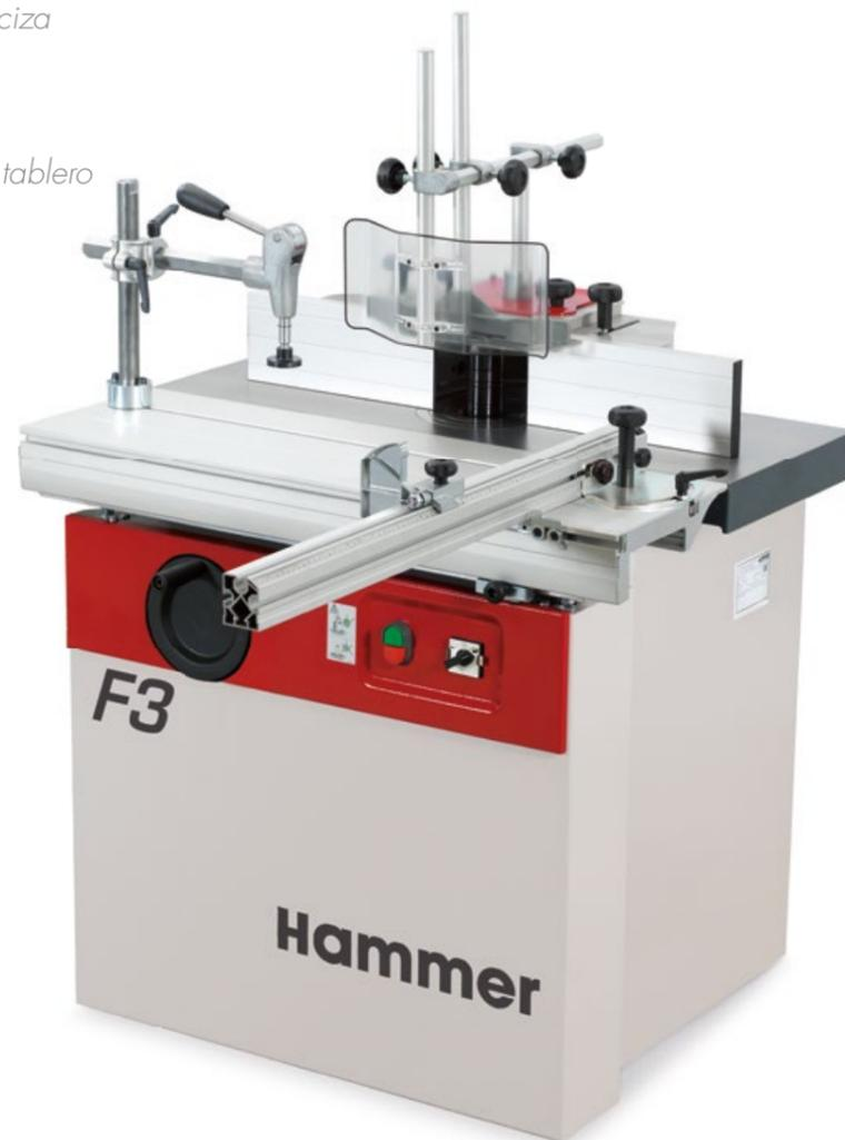
El rápido cambio de las 4 velocidades, ajustes precisos en muy poco tiempo, el tope de fresado profesional, el cabezal de fresado inclinable y la mesa de ranurado y espigado: ¡La F3 le ofrece además de una excelente ingeniería mecánica también un concepto de máquina capaz de cumplir los requerimientos más exigentes al menor precio!
