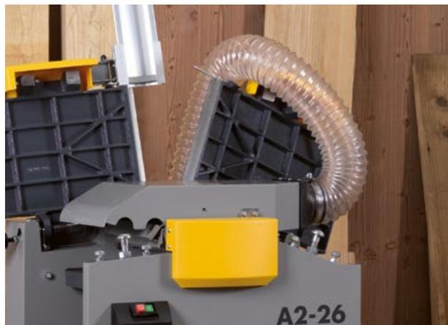
Gain de place et ergonomie : la table de dégauchisseuse ouvrable à l'arrière permet non seulement d'économiser l'espace lors du montage de votre raboteuse Hammer mais assure également un processus de travail ergonomique lors du dégauchissage.
