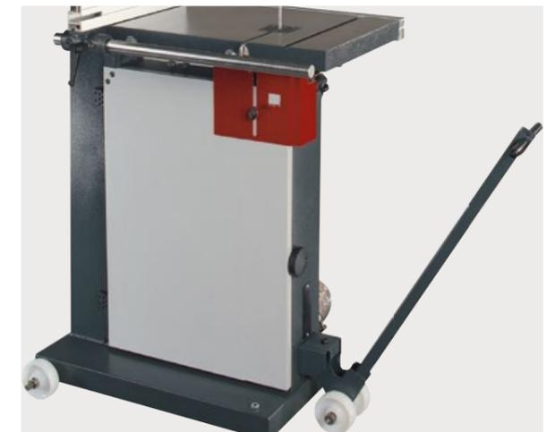
**Mobile tramite il sistema di movimentazione**
