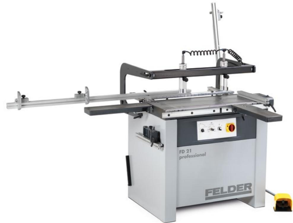
Massima precisione nella foratura per tasselli con la Felder FD 21 professional. Con 21 mandrini portapunta in una griglia di 32 mm per punte dal diametro di massimo 35 mm si garantisce l'esatta foratura multipla e in serie. Il basamento saldato in combinazione con il tavolo in ghisa massiccia, le stabili battute laterali e longitudinali, nonché il pressore pezzo pneumatico ed elementi di controllo ergonomici rendono la FD 21 professional una macchina di foratura multipla di classe superiore.
