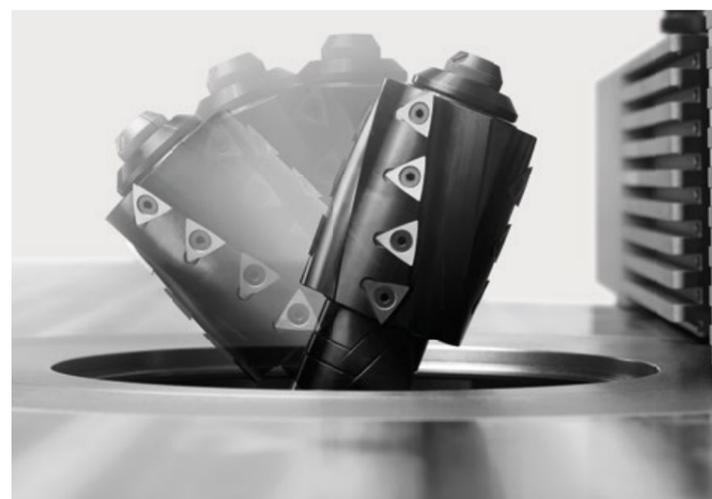
**Диапазон угла наклона +/- 46 градусов обеспечивает безграничные возможности обработки.**
