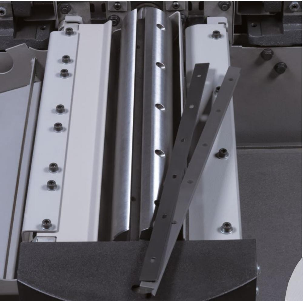
**3-ёх ножевой строгальный вал с быстросменными самонастраивющимися ножами, основная деталь каждого фуговального станка Hammer.**
