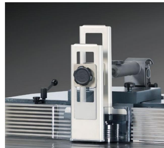
**Защитное ограждение фуговального агрегата "Centrex"**
